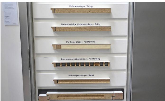
! Für jede Anforderung der passende Türblattaufbau: Lebo bietet eine große Vielfalt an verschiedensten Türblattaufbauten.
