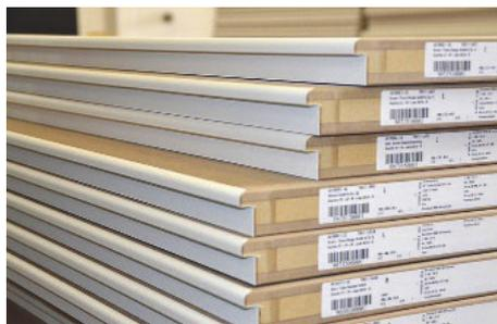
*/ Die Postforming-Türen werden am Übergang zwischen Falz und Türblattfläche mit Lack versehen.*
