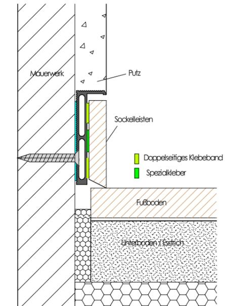
Sockelleiste Light 46 in Massivbauwand
