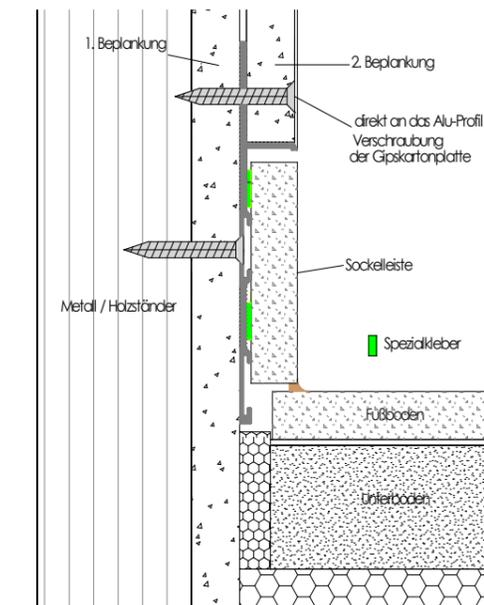
Sockelleiste C70 in Trockenbauwand
