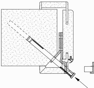
Das Mauerwerk auf Höhe des Befestigungswinkels ansträgen.
