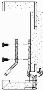
Den Befestigungswinkel mit den 4 beiliegenden Schrauben in Höhe der Riegelausnehmung an der Schließblechplatte anschrauben.
